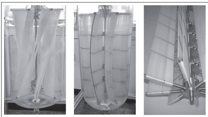
Abbildung 5. Fotografische Ansicht einiger untersuchter DMA-Konfigurationen im 100-L-Maßstab: 18° gegenüber der Vertikalen angestellte Membranen links, 12° seitlich ausgeformte Membranen mittig (Profil durch eingezeichnete Linie verdeutlicht) und einseitig abgestützte Membranen rechts.
